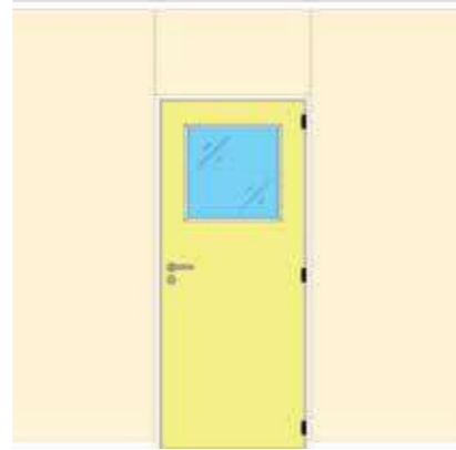
③ ENKELE DEUR HOUT, beglaasd met kleine glaskader
