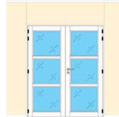
⑭ DUBBELE ALUDEUR, beglaasd met dwarsliggers
