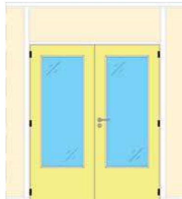
⑨ DUBBELE DEUR HOUT, beglaasd met grote glaskaders
