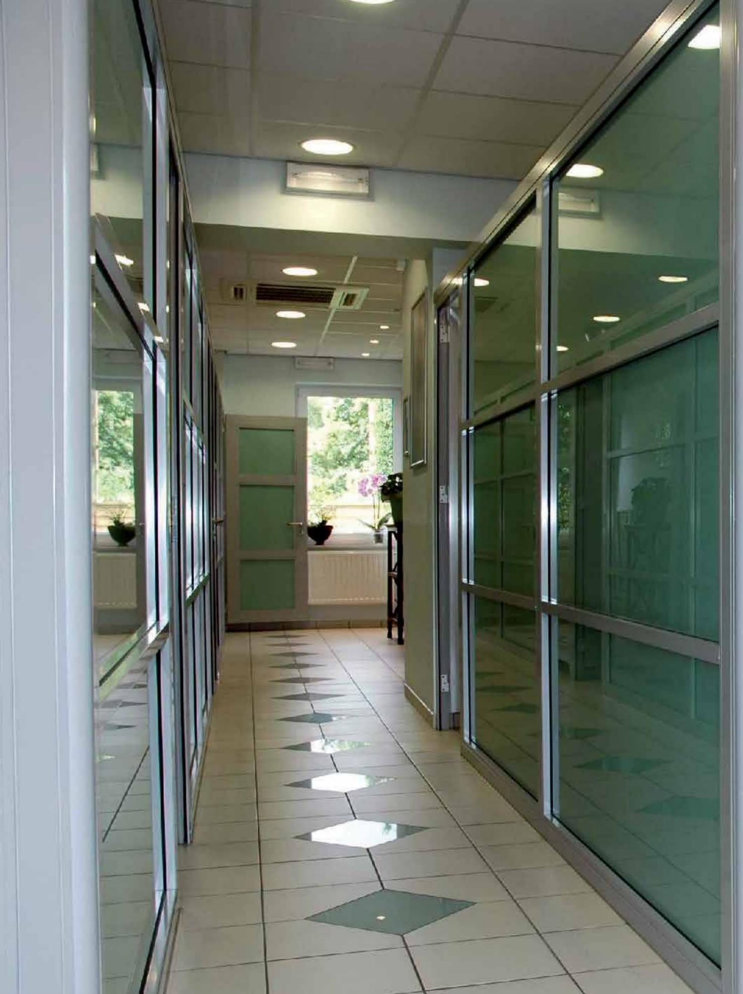
*EUROCLOISON-SR est sans conteste le fleuron de la gamme EUROCLONSON. L'assemblage de ce système universel se déroule entièrement en atelier ; il comprend le montage des deux panneaux d'habillage pourvus de leur isolation et des éventuelles parties vitrées et portes. Les modules de cloisons amovibles arrivent sur chantier en tant que produits finis, prêts à être posés.*
