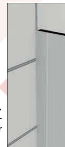
Pour le raccord entre les murs et les cloisons, il est fait usage de profils en aluminium extrudé. Ceux-ci sont laqués dans la couleur des panneaux.
